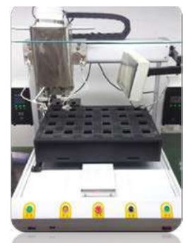
半自動化外殼引線焊接機
