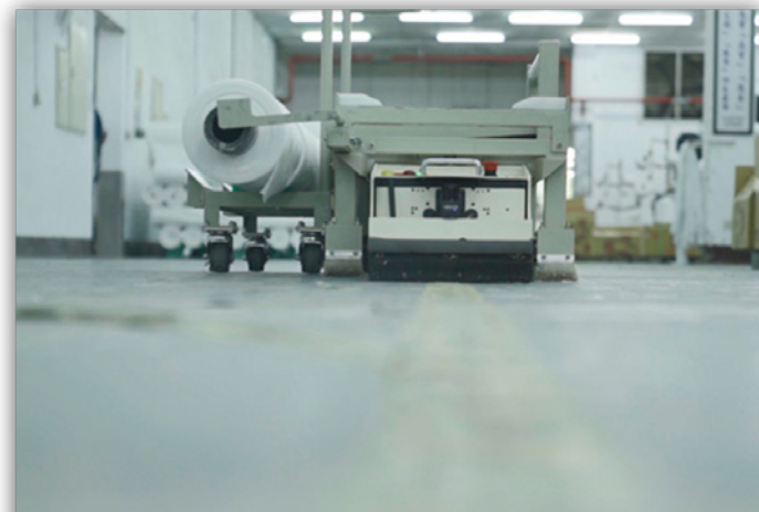
圖 1:AGV 無人搬運車可透過雲端智慧技術，自動到達完成織布工作的機台，搬運布料 (註 1)
