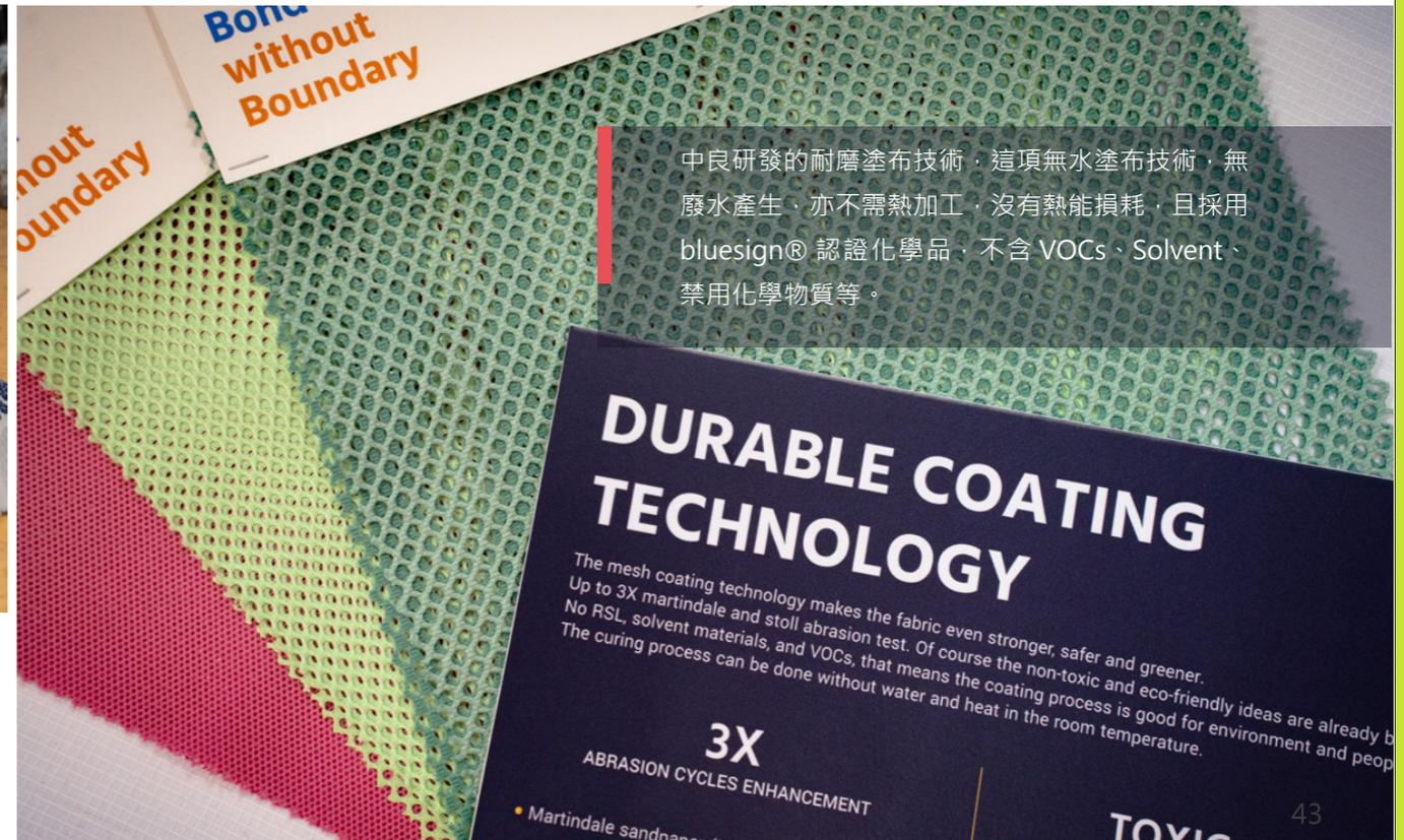
中良研發的耐磨塗布技術，這項無水塗布技術，無廢水產生，亦不需熱加工，沒有熱能損耗，且採用 bluesign® 認證化學品，不含 VOCs、Solvent、禁用化學物質等。
