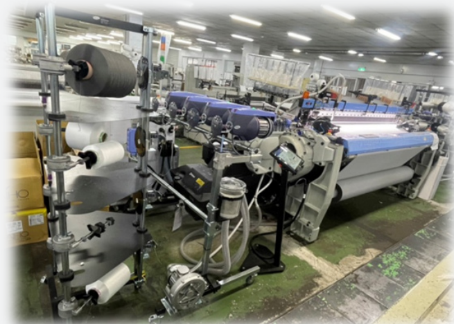
圖 2. 高效節能性能優異的 ITEXA R9500 EVO 劍槌式織布機。
